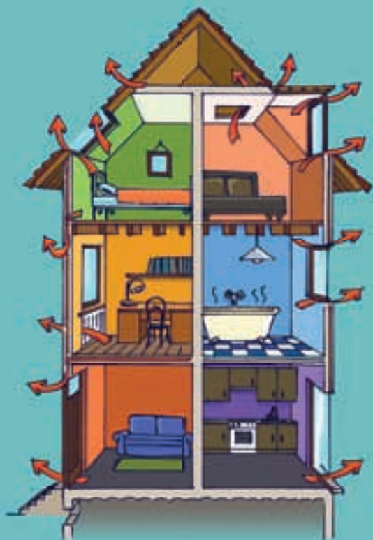
Les fuites d'air dans un logement non étanche à l'air
